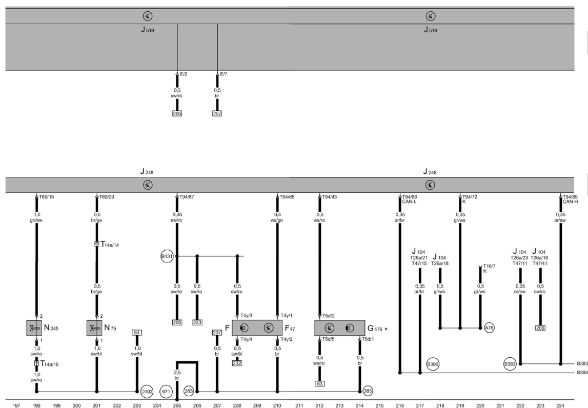
CONTACTEUR DE FEUX STOP, ÉLECTROVANNE DE LIMITATION DE PRESSION DE SURALIMENTATION, CALCULATEUR DE SYSTÈME D'INJECTION DIRECTE DIESEL, VANNE DE COMMUTATION DU RADIATEUR, PRISE DIAGNOSTIC, CAPTEUR DE POSITION DE L'EMBRAYAGE (moteur BMM 8 sur 10).
